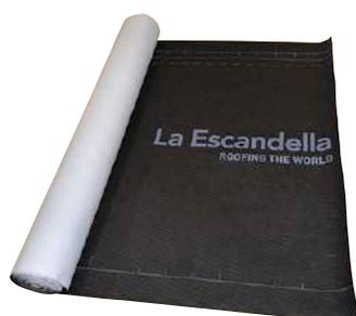
Membrana impermeable de alta transpiración compuesta por 3 capas unidas por termosellado. Los distintos gramajes permite la elección de una mayor o menor permeabilidad al vapor del agua, siendo impermeables al agua y al viento.
